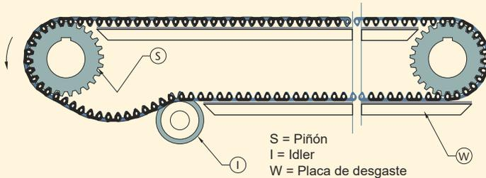
• **Guía De Apoyo:** En la mayoría de las instalaciones, la cadena está apoyada en toda su anchura sobre guías de apoyo de acero endurecido. Es importante llevar a cabo una inspección periódica de las mismas, ya que el desgaste excesivo puede provocar que la cadena se desgaste rápidamente y de forma no uniforme. Normalmente, se desgastará más rápidamente en el centro de la cadena donde soporta mayor carga.
