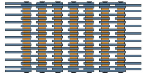
**Malla-Espaciador (S)** En este tipo de montaje, los espaciadores se sitúan entre las mallas para reducir el peso, reducir la superficie y aumentar el paso de aire a través de la cadena. El mayor espacio entre uniones también permite la caída de la suciedad a través de la cadena, evitando su acumulación.
