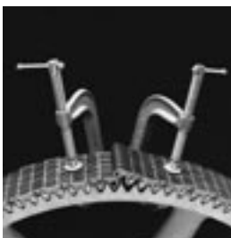
Chaîne symétrique reliée pendant le raccordement.
