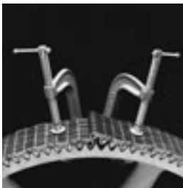
Chaîne symétrique reliée pendant le raccordement.
