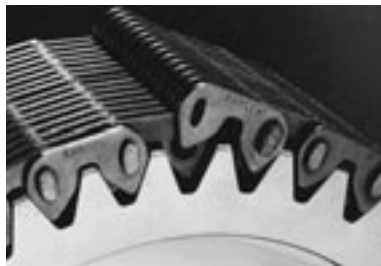
Chaîne emboîtée sur le pignon pour simplifier la connexion.
