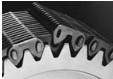
Symmetrisches Zusammenfügen der beiden Kettenenden
