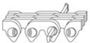
Einführen des Splintzapfens als erstes durch das Zapfenloch
