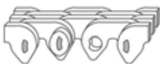
Zusammenfügen der Enden, dass die Zapfenlöcher fluchten
