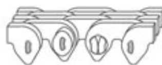
Nachschieben des Wiegezapfens mit dem konvexen Rücken gegen den konvexen Rücken des Splintzapfens
