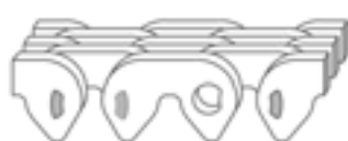
Zusammenfügen der Enden, dass die Zapfenlöcher fluchten
