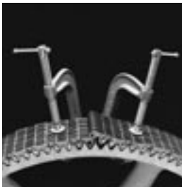
Zahnkette mit den beiden Enden übers Rad gelegt erleichtert das Verbinden
