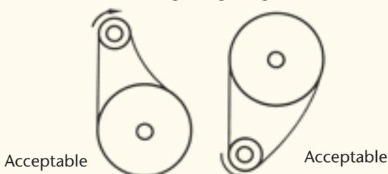
Ist der Wellenabstand verhältnismässig klein, sollte das lose Kettentrum unten sein. Ist das lose Trum oberhalb des Triebes, kann dies zu einem Überspringen der Zahnkette beim Zahnkettenrad führen.
