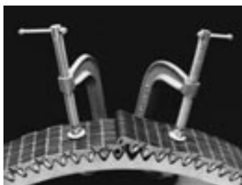
Catena bloccata sull'ingranaggio per semplificarne la chiusura.
