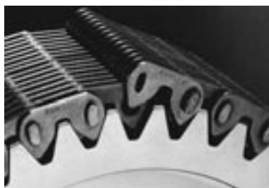
Sovrapposizione simmetrica dei lembi della catena
