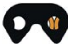
Junta das correntes RPV e RC com pinos em forma de "Crescente"
