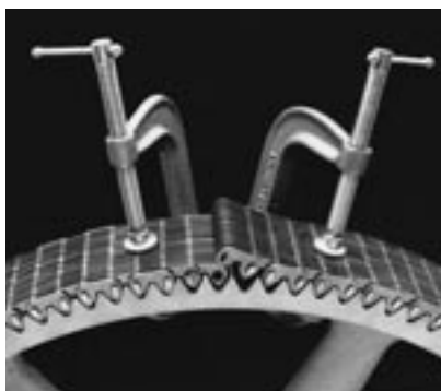
Corrente grampeada à engrenagem para facilitar a conexão.
