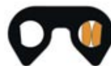
Junta da corrente SC com pinos em forma de "D"
