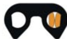
Junta da corrente SC com pinos em forma de "D"
