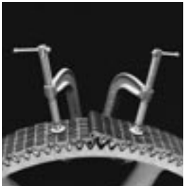
Cadena fijada al piñón para facilitar la conexión.
