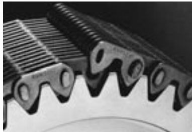
Entrelazado simétrico durante la conexión.
