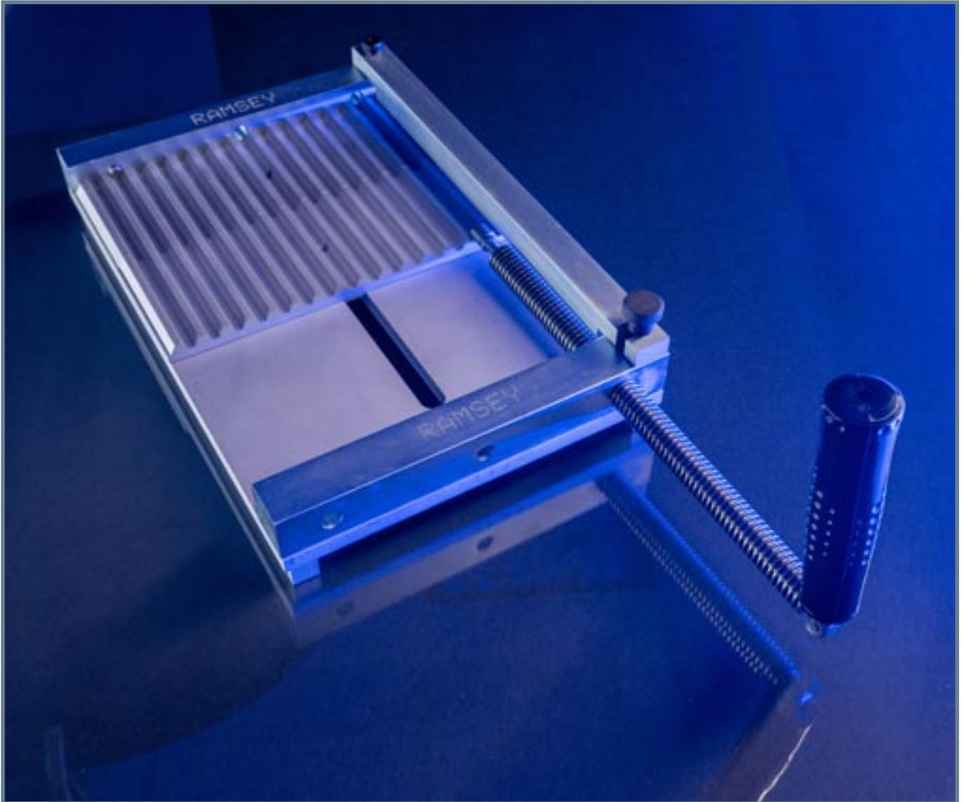
RKO链条连接可以快速简便的通过使用预钻孔的输送机连接销和坚硬的热处理垫圈和驱动螺钉完成连接。要使用这种类型的连接，请确保为您希望连接的链条订购预钻孔连接部件套装。如果您更喜欢使用标准退火类型的连接销子，您仍然可以使用RKO工具断开链条，工具的齿形导向板将有助于保持连接过程中的链接和间隔对齐。请注意，使用标准的连接销子，你仍然需要用锤子敲开连接销子的末端。
