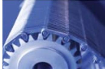
Ramsey的All-Steel链条是由100%钢制成的耐磨防护型链条。不同于其他使用压制金属制成的销头保护链，容易开裂，All-Steel链条使用100%硬化的合金钢制成的防护链条。
