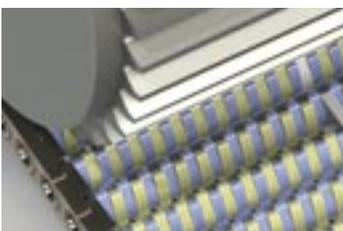
El sistema patentado de Ramsey de cadenas R-Select permite a los usuarios de cadenas de transporte seleccionar exactamente donde ellos requieren mejorar la resistencia al desgaste en una cadena. Durante la producción de la cadena, eslabones altamente resistentes al desgaste se insertan a lo largo de la cadena, o en ubicaciones específicas, dependiendo de la preferencia del cliente. Como resultado, una acentuada resistencia al desgaste estará disponible en donde tu mas la necesitas.
