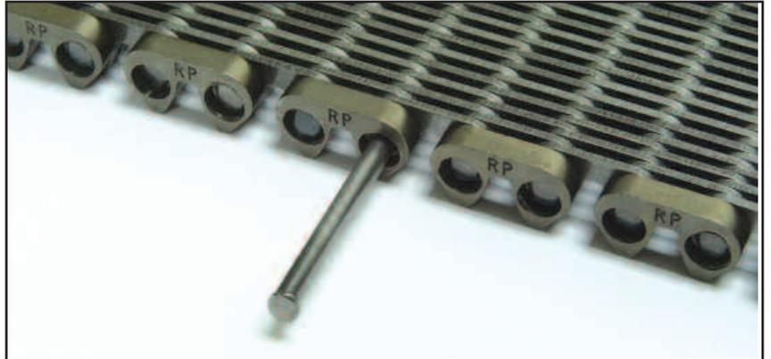
7) Auf der Seite der Kette, wo sich die Verbindungsflasche befindet, vernieten Sie nun das Ende des Verbindungsbolzens mit einem kleinen Hammer. *Während der Vernietung des Verbindungsbolzens ist es notwendig, die Kette zu fixieren, um zu verhindern, dass er am anderen Ende der Kette herausfällt.*
