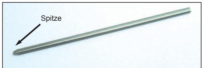
4) Schieben Sie das spitze Ende des Ausrichtungsstiftes durch die Löcher der Kette. Leichtes Klopfen mit einem kleinen Hammer kann dabei helfen. Dann entfernen Sie den Ausrichtungsstift.
