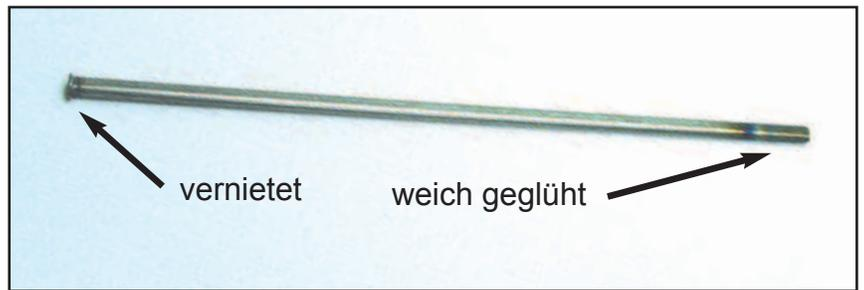
6) Gehen Sie zur anderen Seite der Kette und führen Sie das nicht vernietete, weich geglähte Ende des Verbindungsbolzens durch die Löcher der Kette ein.
