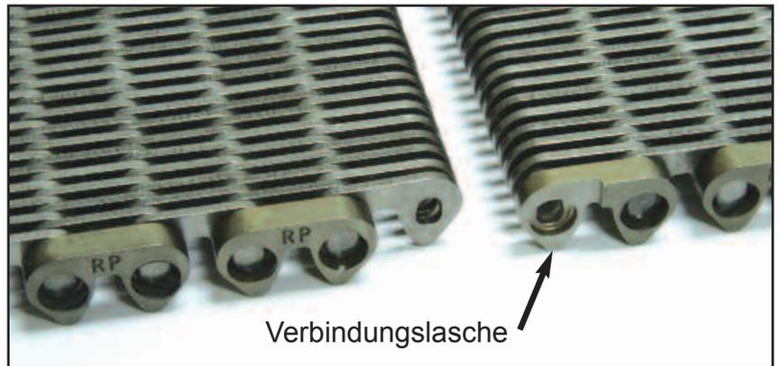
2) Fügen Sie die Enden der Kette zusammen, so dass die Löcher in den Laschen in einer Reihe sind.
