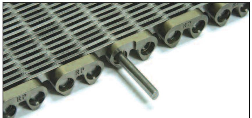
5) Nehmen Sie jetzt den Verbindungsbolzen, der an einem Ende vernietet und am anderen Ende weich gegläht ist, zur Hand.
