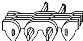
2. Entfernen Sie den langen und den kurzen Bolzen aus der Kette.
